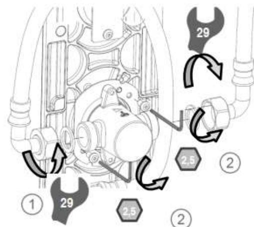
Tout d'abord, dévisser soigneusement à l'aide de la clé plate 29 les deux écrous situés de part et d'autre de la cartouche temporisée, puis ôter les vis qui la maintiennent en place à l'aide de la clé Allen 2.5.
