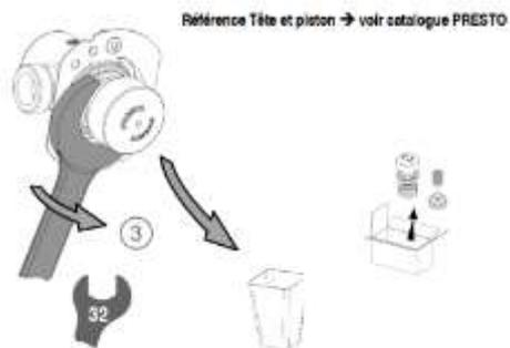
Retirer alors la cartouche temporisée en la dévissant à l'aide de la clé plate 32, jeter la cartouche usagée dans une poubelle prévue à cet effet, puis la remplacer par une nouvelle, préalablement commandée.
