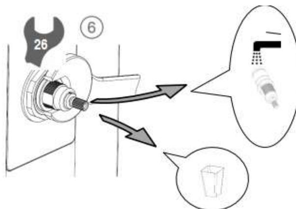
Retirer ensuite la cartouche mitigeur en la dévissant à l'aide de la clé plate 26, laver la cartouche usagée à l'eau ou la jeter dans une poubelle prévue à cet effet, puis la remplacer par une nouvelle, préalablement commandée.
