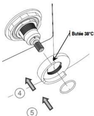
ATTENTION : Prendre soin de mettre la butée à 38 degrés lors du remontage insérer ensuite le joint.
