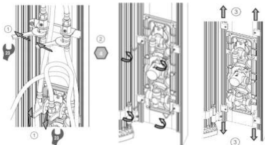
Commencer par dévisser à l'aide de la clé plate 23 les écrous des flexibles.
