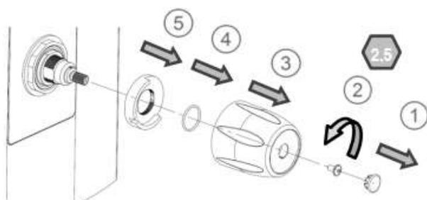
Enlever tout d'abord le cache-vis, puis dévisser la vis à l'aide de la clé Allen de 2.5, retirer alors l'ensemble vis, bouton, joint et butée.
