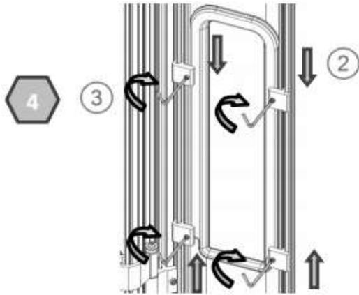
Remettre en place les encoches en les faisant glisser le long des rails, puis visser de nouveau avec la clé Allen 4
